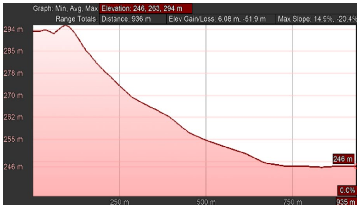
Imagine 5.11 Profil longitudinal - Rigola str. Tarniței
