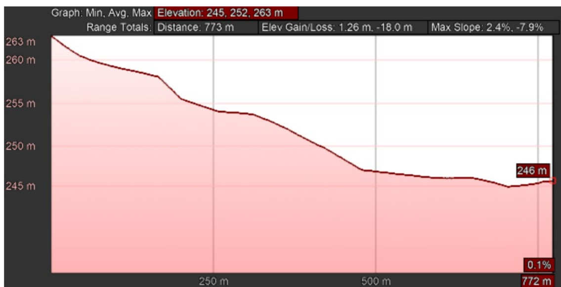
Imagine 5.12 Profil longitudinal - Rigola str. Pădurii
