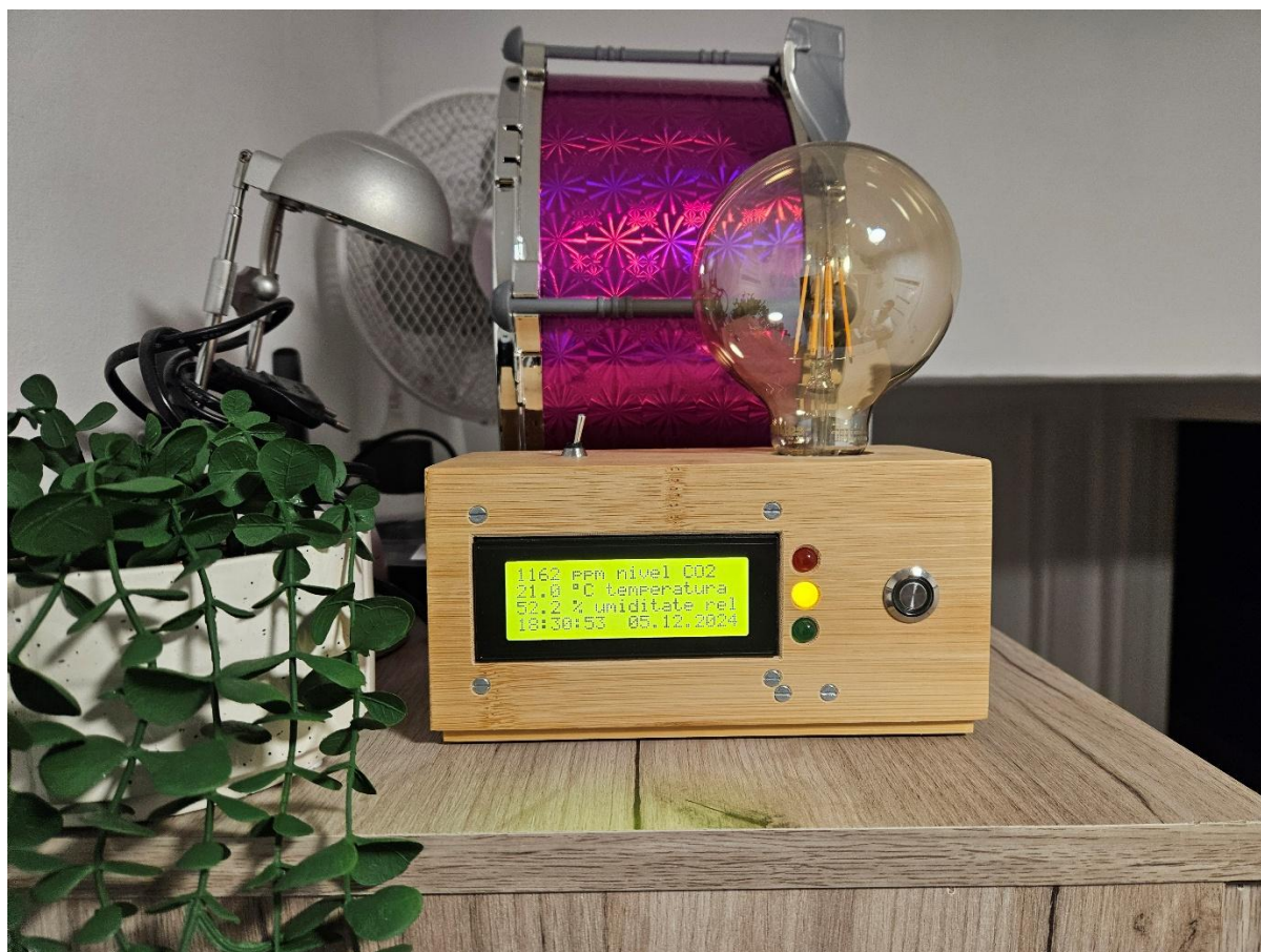
Dispozitiv ALEA HomeMonitor care afișează concentrația de CO 2 , temperatura aerului și umiditatea relativă în timp real
